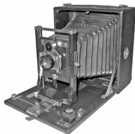
写真1 ポニー・プレモ4号 Pony Premo No.4 レンズ:5×7 プラナトグラフ 5X7 Planatograph 8.5インチ(21.5cm) F8~F128。シャッター:ボシュロム(Bausch & Lomb) エア式 T、B、1、2、5、25、50、100。1/5秒以下スロープランジャーが作動。 本体は木製革張り、蛇腹は赤革、レンズボード、鳥居、ベッドは木製ニス塗りである。写真中央下には本来反射ファインダーが付いている場所だが、欠品のため水準器を載せてある。
