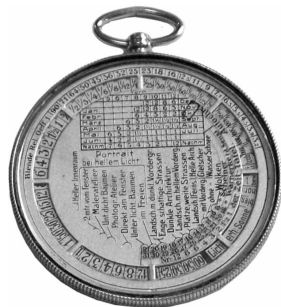
コンテッサネットル露出計。金属製で一見懐中時計と見間違えるが円形計算尺方式。1926年以前のもの。
