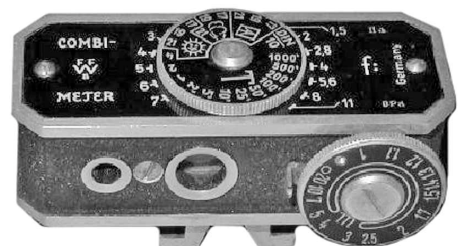
光学露出計と距離計が組み合わされたもの。左はTELE-BEWI ドイツ製で1930年頃の製品。右はCOMBI METER(ドイツ製)は1950年頃の製品。
