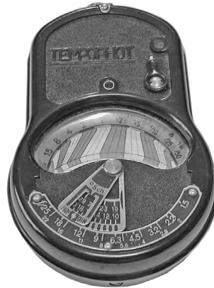
光学露出計Wirgin (アメリカ1950年頃)。横から覗き込む形式で、同じようにやっ見える数字を上面の計算尺に移して露出を決定する。
