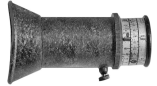
光学露出計Justaphot (ドイツ1930年)。筒の中の数字を読む形式。
