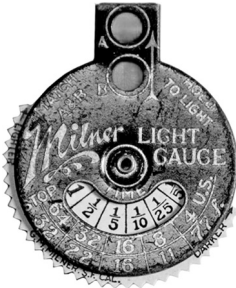
Milner Light Gauge (英1900年頃)。光学露出計と感光物質露出計の中間的露出計。上の丸窓Aを被写体に向けその明るさと下側の丸窓Bの明るさを同じになるよう本体外周のギザギザを回す。中枠窓と外枠の数値を読み取り露出を決定する。
