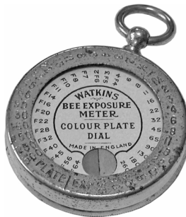
The Watkins Bee Exposure Meter。英国製で1905年から1910年まで製造された。
