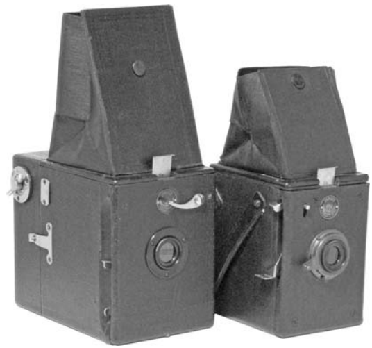
イハゲーが後に一眼レフ専門になるきっかけとなったのが1921年に発表された木製の小型一眼レフ、“パフ”レフレックスで、シンプルなミラーシャッターをもつ。左は1923年の120フィルムに6×9cm判を撮るロール・パフ・レフレックスで、F11の単玉付き。右は4.5×6cmのアトム判乾板用プラン・パフ・レフレックスで、トリオプラン80mm F6.8付き。
