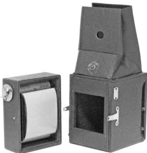
ロール・パフはバックを外してフィルムを装填するので(途中交換はできないが)ハッセルブラッドの遠い祖先といわれる。
