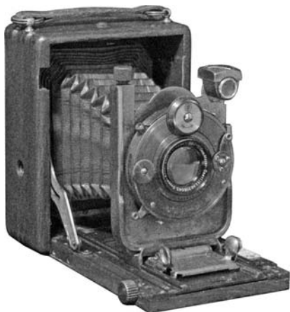
1912年以降のイハゲー・カメラは典型的なドイツ型ハンドカメラであった。これはそれらの中でも有名だったノイゴルトの6.5×9cm判で、1922年頃のものだ。トロピカル仕上げで、旧コンパー・シャッターまで金色仕上げだ。レンズはマイヤーのフェアプラン105mm F5.5で、2段伸ばし、上下・左右のシフトあり。
