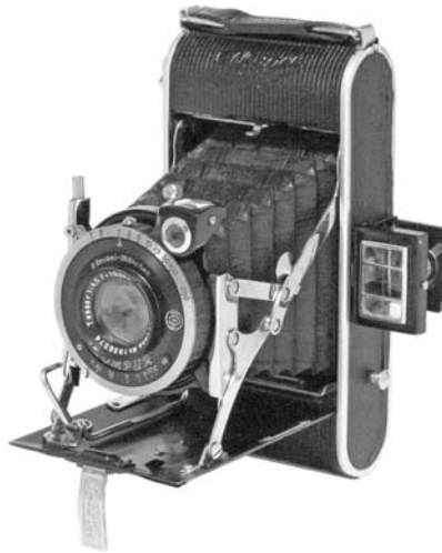
1933年ツヴァイフォーマット・アウトウルトリックス。テッサー105mm F4.5を直進ヘリコイド・マウントに入れた高級機で、4.5×6cm判と6×9cm判のダブル・フォーマットや裏蓋が乾板兼用になったものもある。
