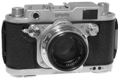
写真8 ロボットの究極モデル、1956年発売のロイヤル36S。24×36mm判で連写モードを持つ。35mmフルサイズになった結果、1回のフル巻き上げで撮れる枚数は16になった。距離計連動。50mm、F2のゾナー付きでちょうど1kgと重い。1956年に連写機能が付いたときにはロイヤル36Sと刻印されたが、最後の1969-1971製ではロイヤル36Iに戻った。
