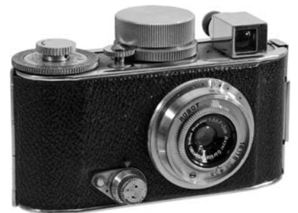
写真 7 真の意味で35mm自動巻き上げカメラの祖と言える1934年のロボットI型。I型ではファインダーブロック全体が右へ90度回り、横向き撮影ができる。まだシンクロはなく、シャッターダイヤル横の三角形のレバーは黄色のフィルターを掛けるためのもの。
