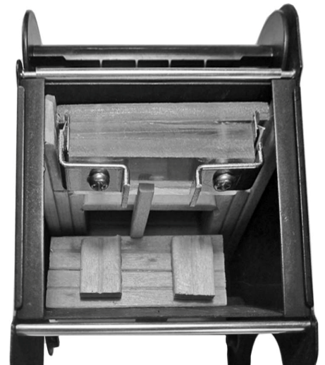
写真1 図1のロールフィルムカッター組付状態
