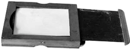
写真3 フィルムホルダーに印画紙をセットする 実際は暗室、または、ほぼ真っ暗にした室内で 取り扱っていただきたい。
