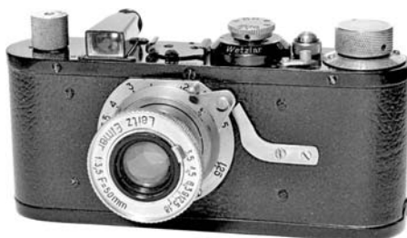
これがモスクワのフェイク・ライカ工房製とされ るフェトⅠ「レフトハンデッド・スペシャル」。左右 はほぼ完全に逆になっており、レンズのヘリコ イドもフィルム/シャッターの巻き上げも逆回転 である。
