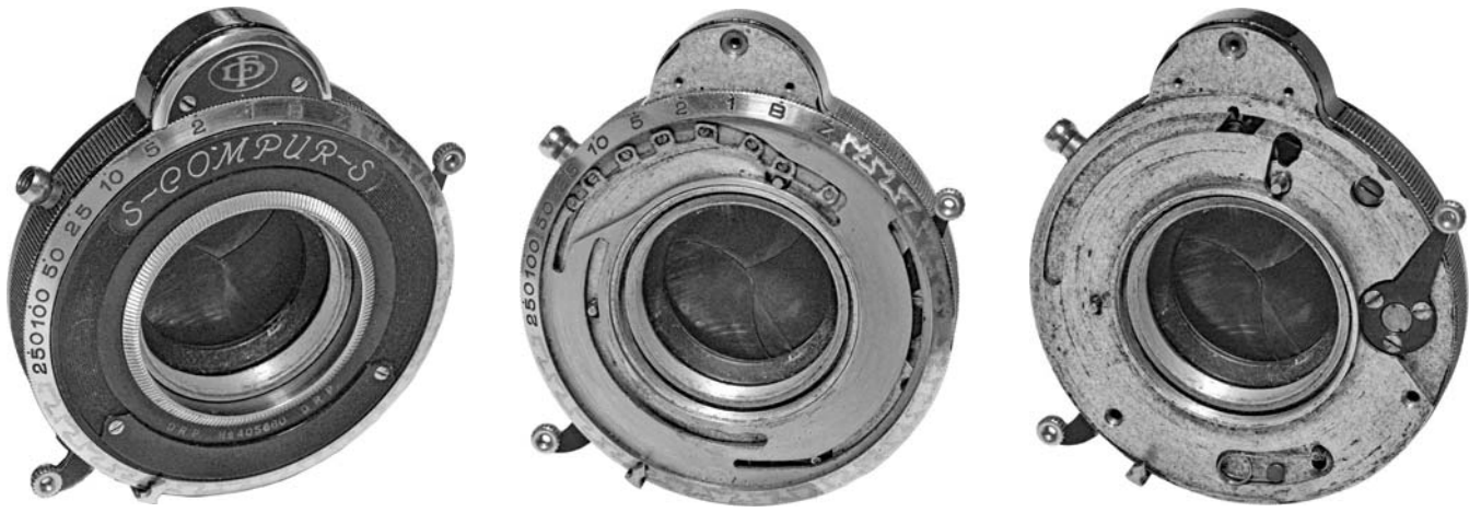
写真(左) 珍しいフリードリッヒ・デッケルの試作シャッター、“S~COMPUR~S”。いわばリムセット・コンパーの prototypes。メインスプリングは旧コンパーと同じ位置にある。リムによる速度選択は量産型とは逆だ。写真(中央)S~COMPUR~Sの最大の狙いはリムセットにある。カムには1速ごとにリフトを変えるための小ネジがついている。写真(右)リムを外したところ。怖いのでまだこれ以上は分解していない。
