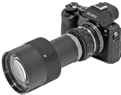
写真21 B69/a 180mm F2.8 メーカー不詳の試作レンズ。 L39マウントは後付けである。
