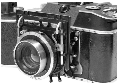
写真7 レンズ、シャッター回りのクローズアップ。直進ヘリコイドを回す“角”が不気味だ。
