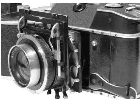
写真8 前板ロックを右へ90度倒すとフィルム前面に遮光幕が上がり、レンズ、シャッターが外れる。
