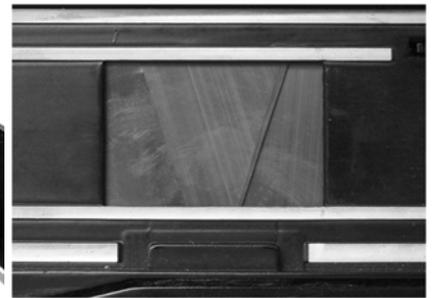
写真 17、18 キエフ 10の金属フォーカルプレーンシャッターとシャッター部分の拡大写真
