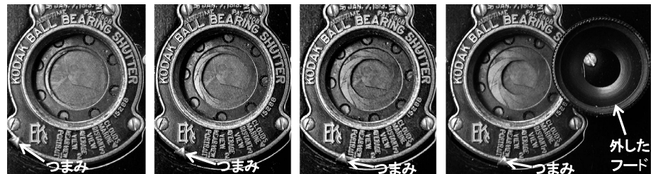
写真4 フード外しの絞りの状態(左から順に、A絞り、B絞り、C絞り、本来の最大絞り位置(絞り1))
