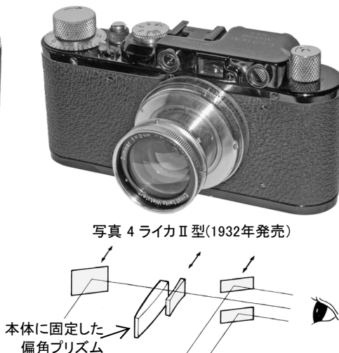
図 8 コダクの距離計、偏角プリズムは本体に固定され、両端ミラーと中央凹レンズがレンズと共に移動する。(野間俊夫著「距離計付カメラの変遷」から)
