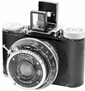
写真2 コダック(ナーゲル)・ピュピレ このピュピレは5cm F3.5のエルマー付だが、画面 サイズが3×4cmと大きいので画角は52度と広い。
