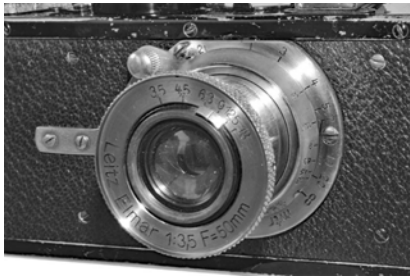
写真1 ライカ I のエルマー5cm F3.5 実焦点距離は51.6mmであった。
