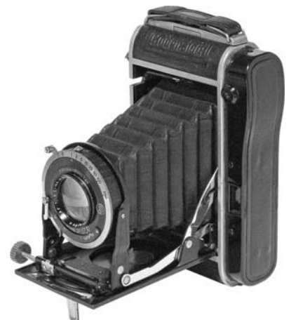
1933年フォクトレンダー・プロミネント 変則的スプリングカメラで、繰り出しはカム。ヘリア105mm F4.5付き。反対側に光学式露出計をもつ。アルミニウム鋳造ボディ。
