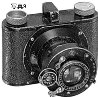
写真9 最初期型:ファインダーはトッププレート中央にある。シャッターは、ダイヤルセットのフロント。レンズはラジオナーF2.9/50mm。トッププレート、ボトムプレート、沈胴式の鏡胴は共に黒色塗装。(McKeown's Cameras 2001-2002より転載)
