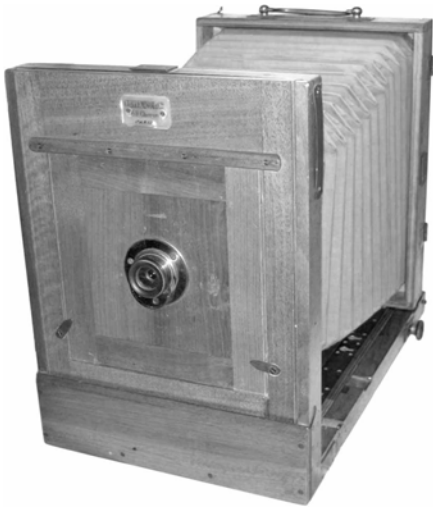
写真6 蛇腹付テールボード型組立暗箱 (1870~80年代、フランス、ギュイミノ社)
