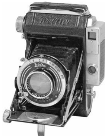
1937年 ヴェルトウール → 6×6cm/4.5×6cm兼用 4.5×6cmと共通のボディで6×6cm 判との兼用としたもの。ボディレ リーズになった。 レンズ:クセナー 75mm F2.8 シャッター:新コンパー T、B、 1-250
