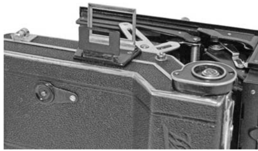
スーパーフェクタ 撮影レンズの後ろにターンテーブルがあり、蛇腹以後が左へ90度 回るレボルビングバック。同時にファインダー内ではマスクが自動 的に切り替わる。
