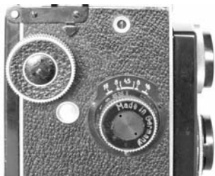
写真13→ ローライコード I aの巻き上げノブとカウンター。
