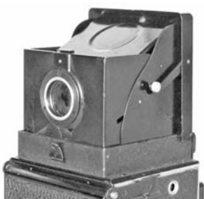
←写真14 ローライコード I aの反射式アイレベル・ファインダー。
