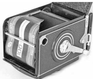
写真16 ローライフレックス・オートマツトのフィルム装填。
