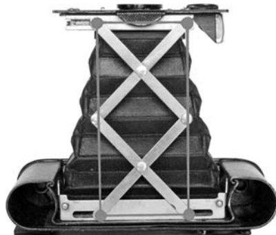
写真11 一杯に伸びた撮影状態のVPK。長方形がレンズの付く前板を支える。
