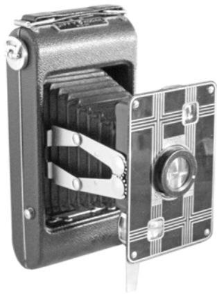
写真5 1933年ジフィー・コダック・シックス20もFPKのセルフエレクトィングの応用。
