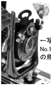
写真3→ No.1イーグル 8×10.5cm判(二段伸 ばし)。木製の鳥居や ベースボードは漆塗り
