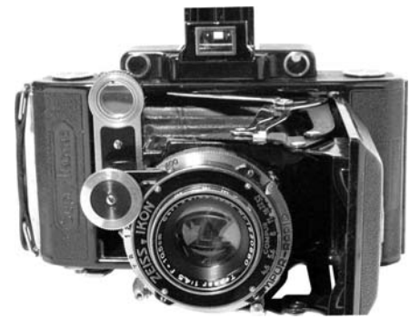
1933年ツァイス・イコン ズーパー・イコンタ I 530/2。あまりにも有名なドレーカイルにより前玉回転のレンズとボディ側の距離計を光学的に結び、基線長65mmの二重像合致式。スプリングカメラ、テッサー105mm F4.5付き。
