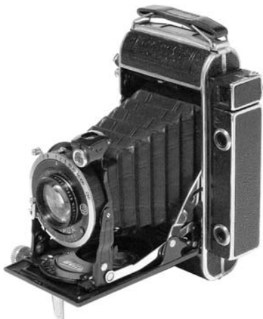
1933年ヴェルタ・ゾリダ セルフエレクトィングで繰り出しはラック&ピニオン。 クセナー105mm F4.5付き。4.5×6cm判との兼用。
