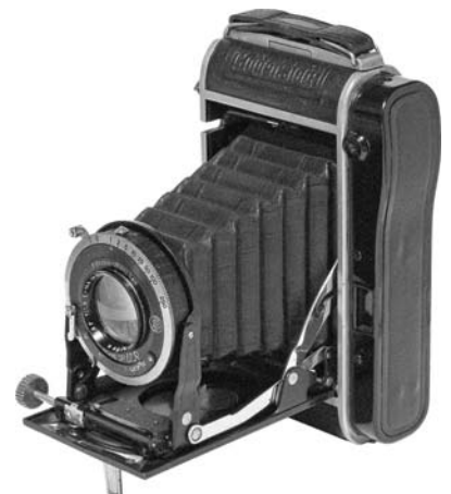
1934年ローデンシュトック・クラロヴィット II 型コンタクス II 型に2年先駆ける初の一眼式距離計ファインダーをもつ。繰り出しはノブとスクリュウ、テコによる。イザール105mm F4.5付き。
