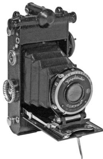
1933年フォクトレンダー・プロミネント 変則的スプリングカメラで、繰り出しはカム。ヘリア105mm F4.5付き。反対側に光学式露出計をもつ。アルミニウム鋳造ボディ。
